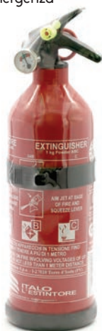
23848 ESTINTORE A POLVERE DA KG. 2 Classe di fuoco: 13A - 89B - C Carica nominale: 2 kg Estringente: ABC MAP 20% Peso totale: 3,7 Kg Diametro serbatoio: 110 mm Altezza: 380 mm Temp. di esercizio: -30° C / + 60° C Valvola: Plastica Supporto: Incluso
